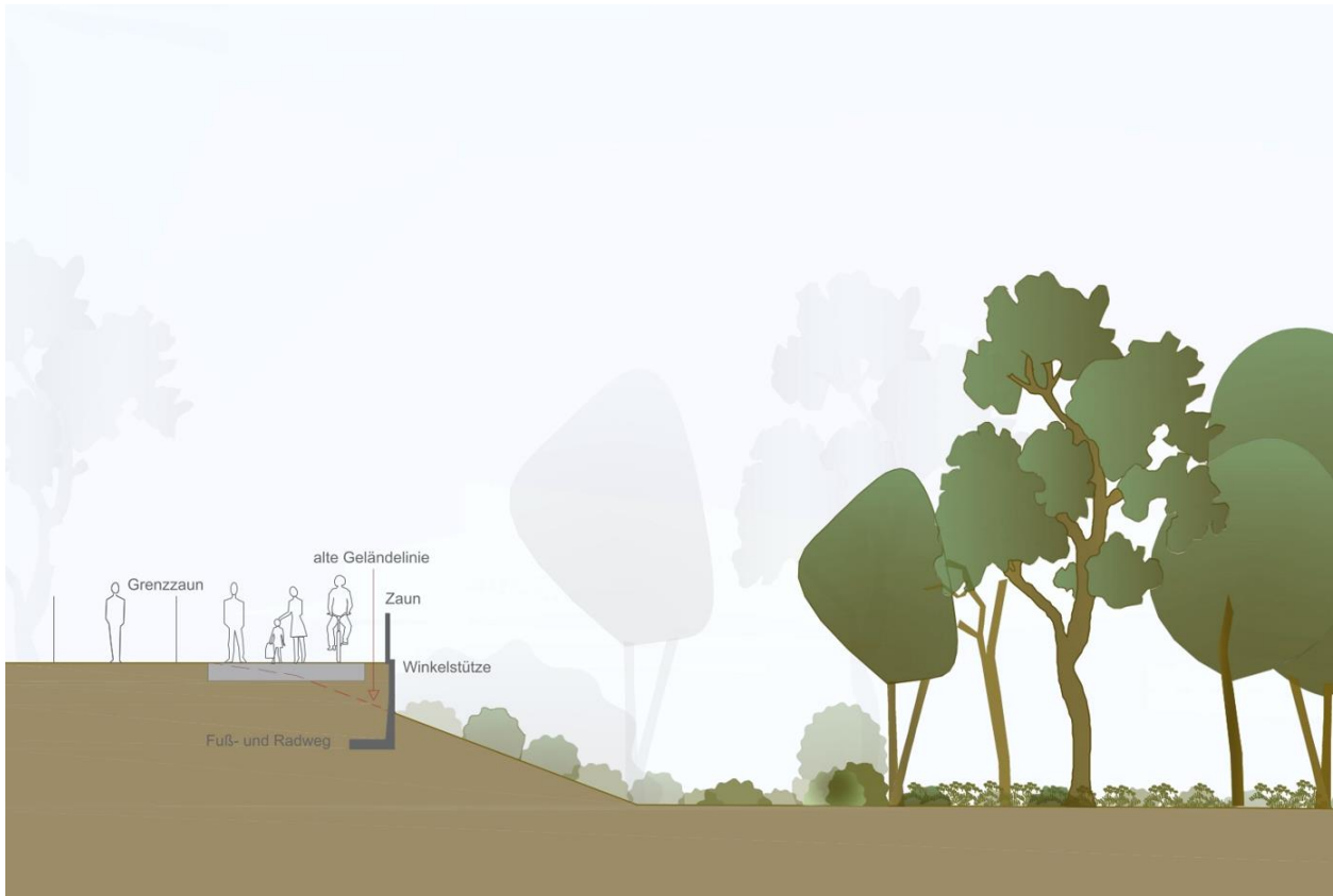
Abbildung 49: Engstelle mit Absicherung durch Winkelstütze
