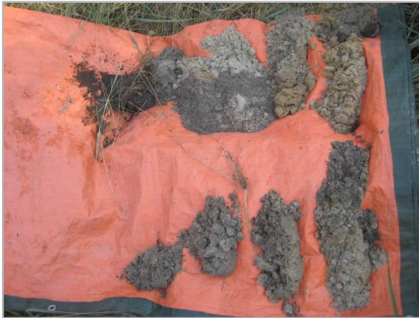
Abbildung 18: Bohrprobe im nördlichen Abschnitt des Regenrückhaltebeckens (11.09.2019)
