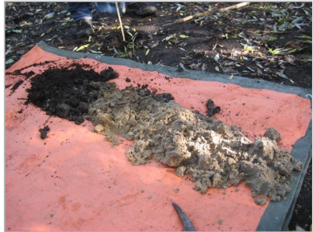
Abbildung 19: Bohrprobe auf Höhe des Einlaufbauwerks im Regenrückhaltebecken (11.09.2019)
