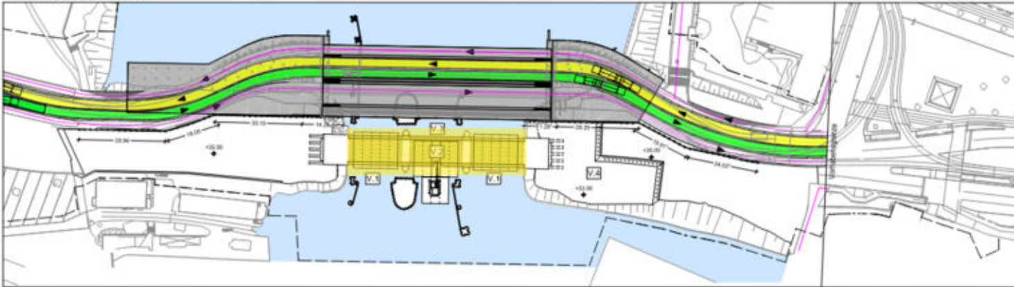
VI. Rückbau Bestandspfeiler Ost und VII. Rückbau Widerlager Ost Draufsicht, M 1:700
