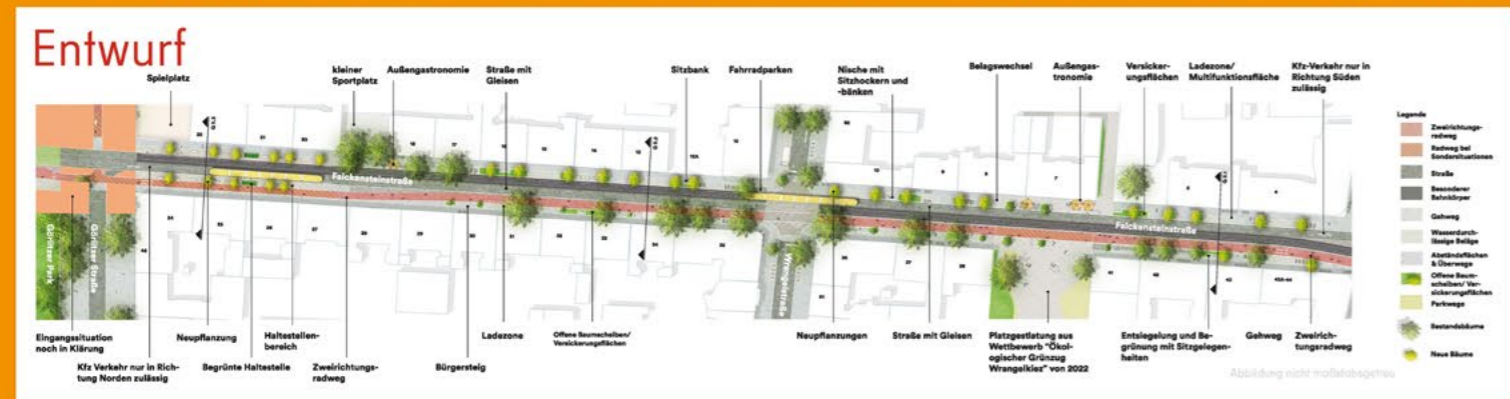
Lageplan Falckensteinstraße - Straßenbündiger Bahnkörper in Mittellage | Quelle: Ramboll
