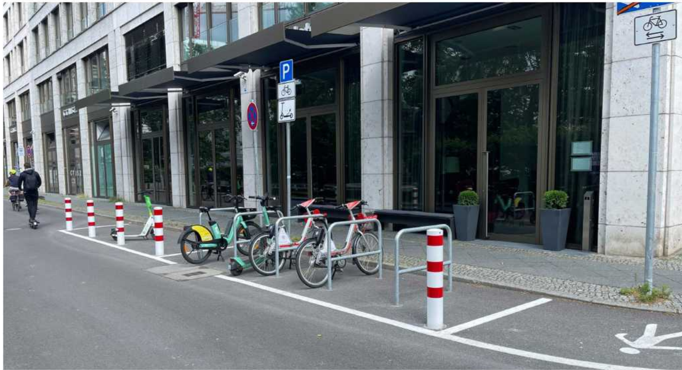
Radabstellanlagen (Kreuzberger Bügel) neben Gehwegvorstreckung
